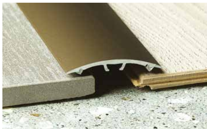
Prechodový profil WELL, šírka 40 mm, nivelácia 0-10 mm
